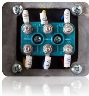
MOTEURS AVEC 6 BORNIERIS DOUBLE POLARITÉ 2 ENROULEMENTS
